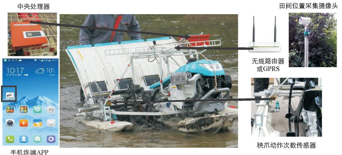
图 2 试验系统装置
