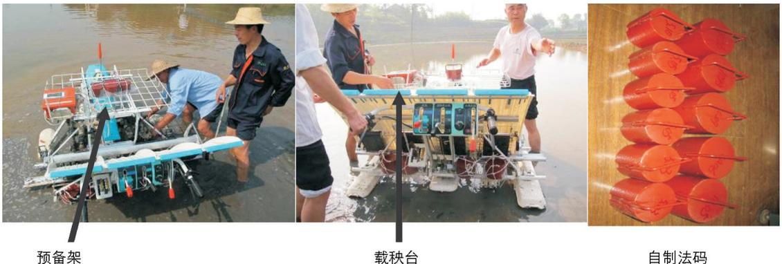
图 3 模拟满载加载配重图
