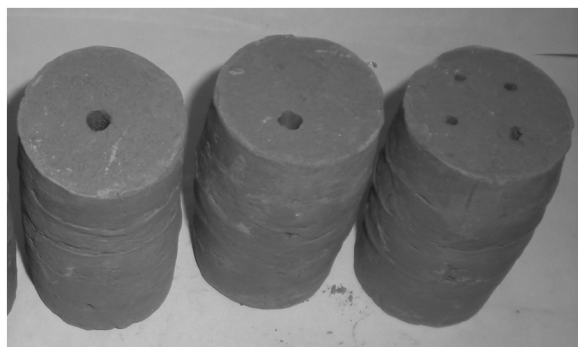
图 1 剪切后试样照片
