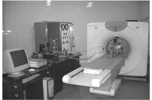
图 3 后勤工程学院 CT-多功能土工三轴仪
