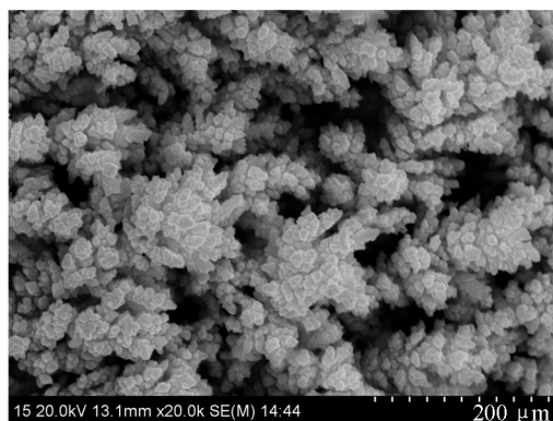
图 1 ERGO-AuNPs/T-NH 2 /Au 电极的 SEM 图
