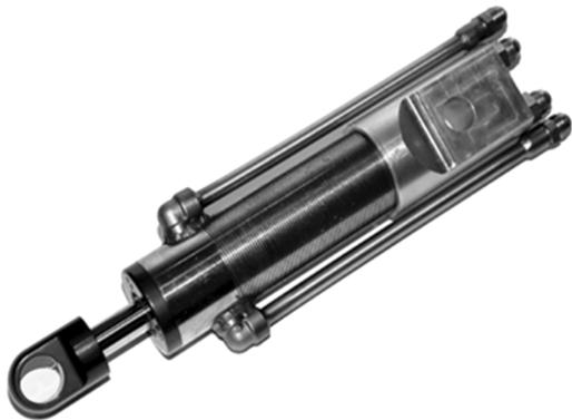
图 1 MIT 开发的能发电的减振器
