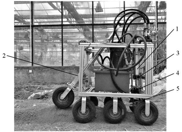
1. 直线位移传感器; 2. 高度检测装置; 3. 液压缸; 4. 液压马达; 5. 刀盘.
