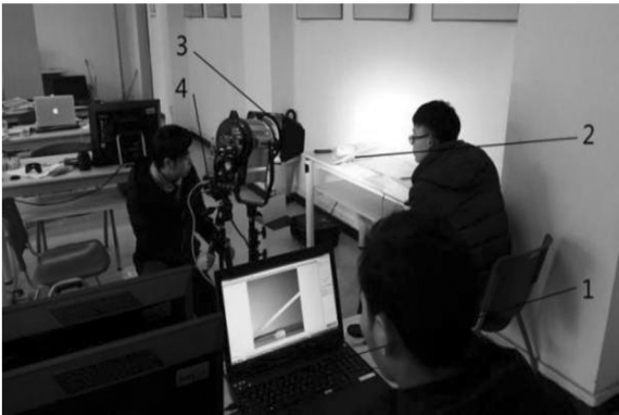
1. 移动工作站; 2. 摩擦系数测定斜面仪; 3. LED 补光灯; 4. 高速摄像机。
