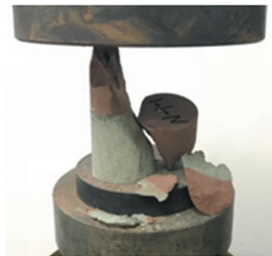
(b) 倾角 0° 层状复合岩样破坏状态
