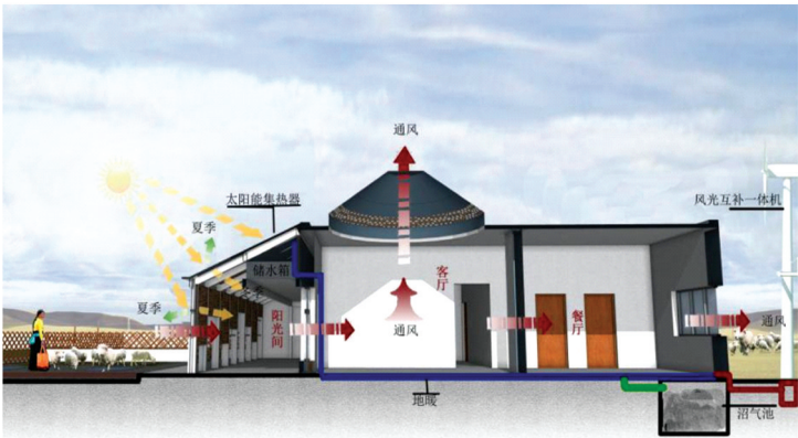
图 3 牧户单元可再生能源利用剖透视示意图
