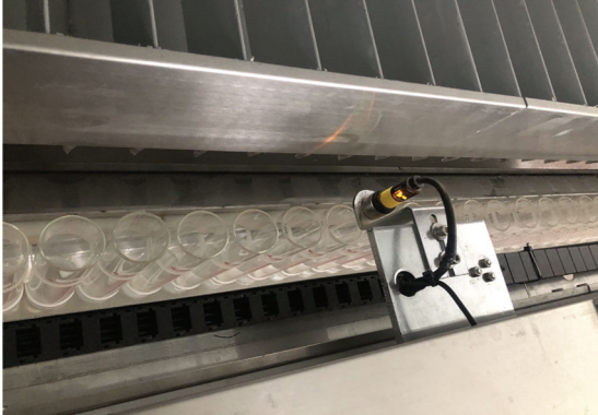
图 15 超声波液位传感器自动读取数据图
