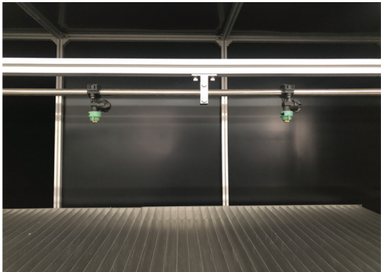
图 11 喷雾性能综合实验平台喷头位置图
