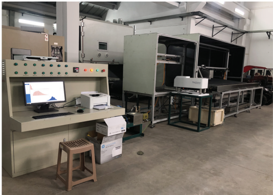
图 10 喷雾性能综合实验平台
