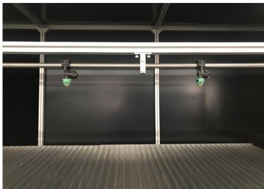
图 11 喷雾性能综合实验平台喷头位置图
