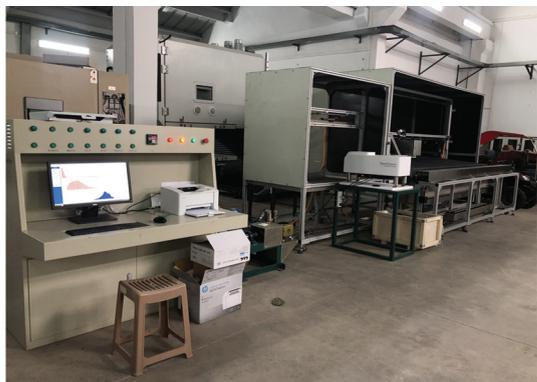
图 10 喷雾性能综合实验平台
