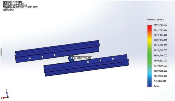
图 3 齿面接触疲劳强度分析结果
