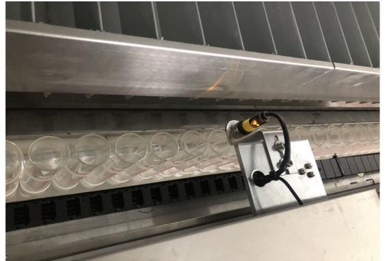
图 15 超声波液位传感器自动读取数据图
