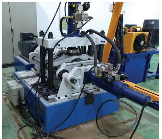
图 6 高铁轮对轴承试验台
