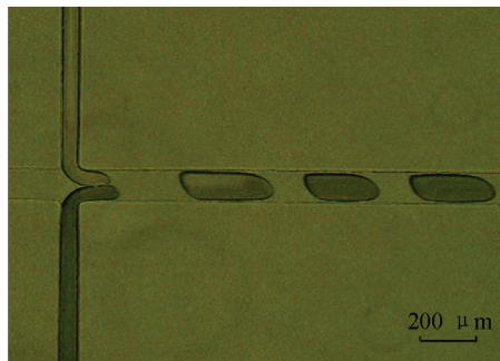
图 4 蓝墨水液滴混合实验图
