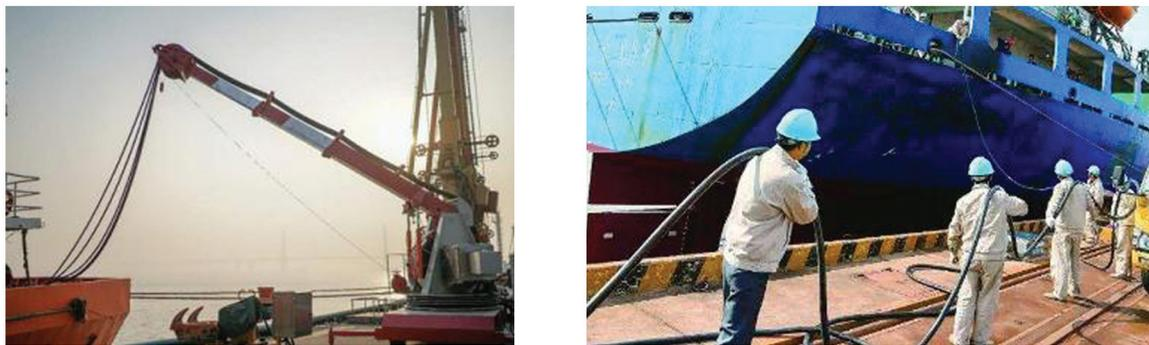
图 2 岸电电缆的连接
