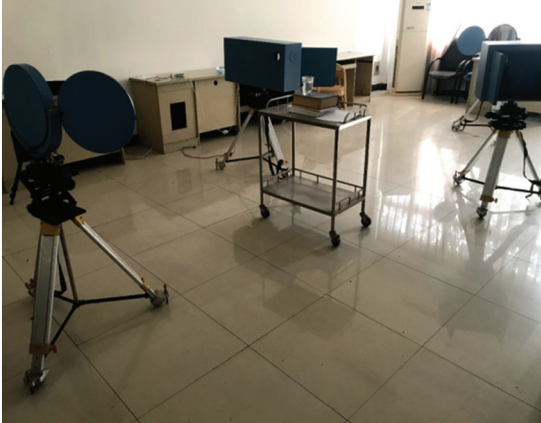
图 2 纹影系统现场布置
