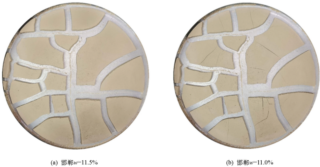
图 2 邯郸膨胀土“次生微裂隙”特性
