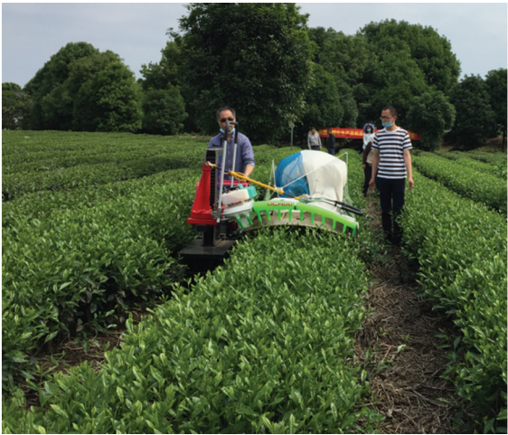
图 4 4CJZ-1000 型自走式采茶机性能试验
