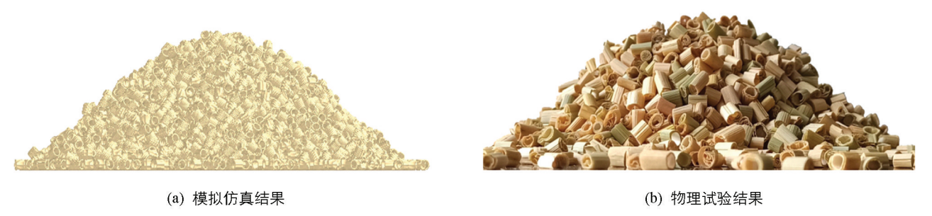
图 7 模拟仿真结果与物理试验结果对比
