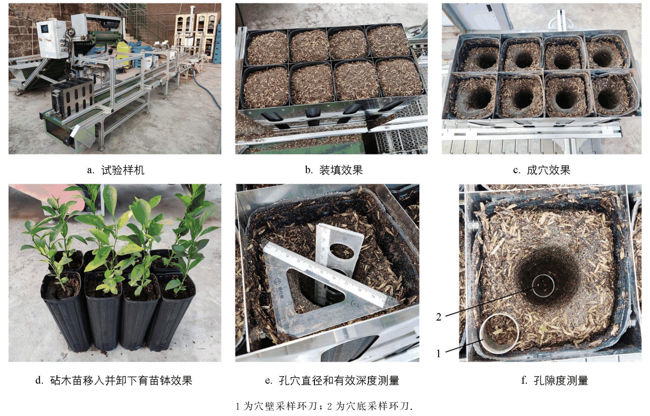
图 10 柑橘育苗钵装填成穴生产线样机试验
