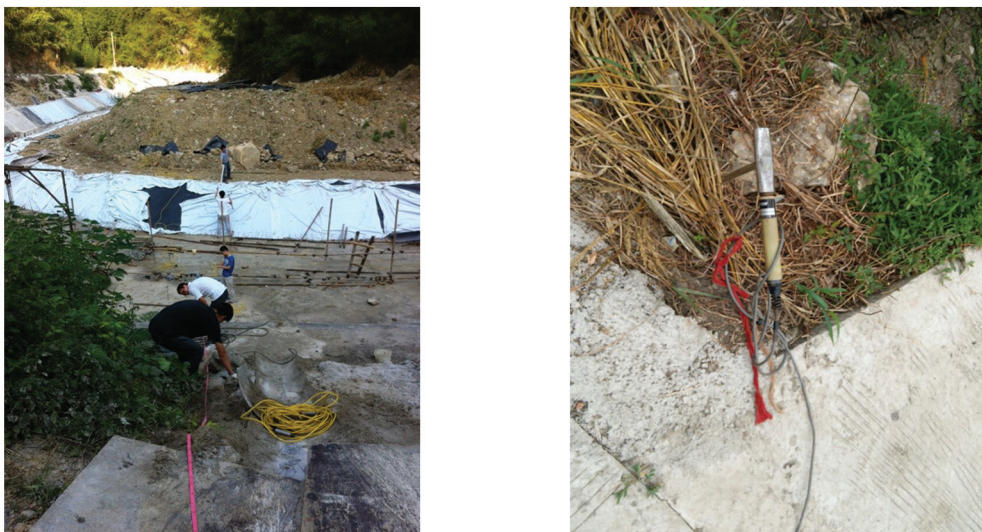
图 3 河流附近 AGI、EH4 法测线现场布置图
