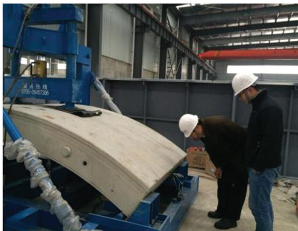
图 1 室内大型抗弯试验
