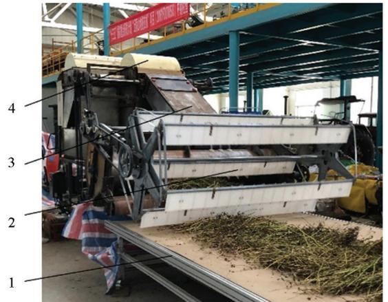
图 8 荞麦捡拾脱粒试验平台
