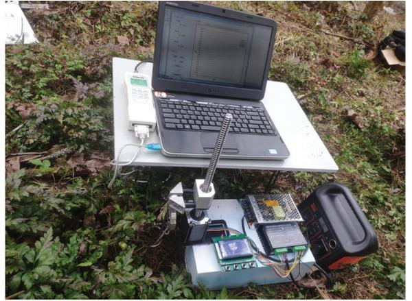
图 4 黄连原位机械拔取测试现场
