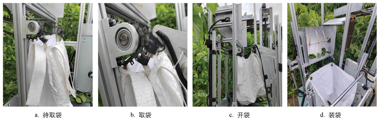
图 11 取袋机构关键运动时刻状态
