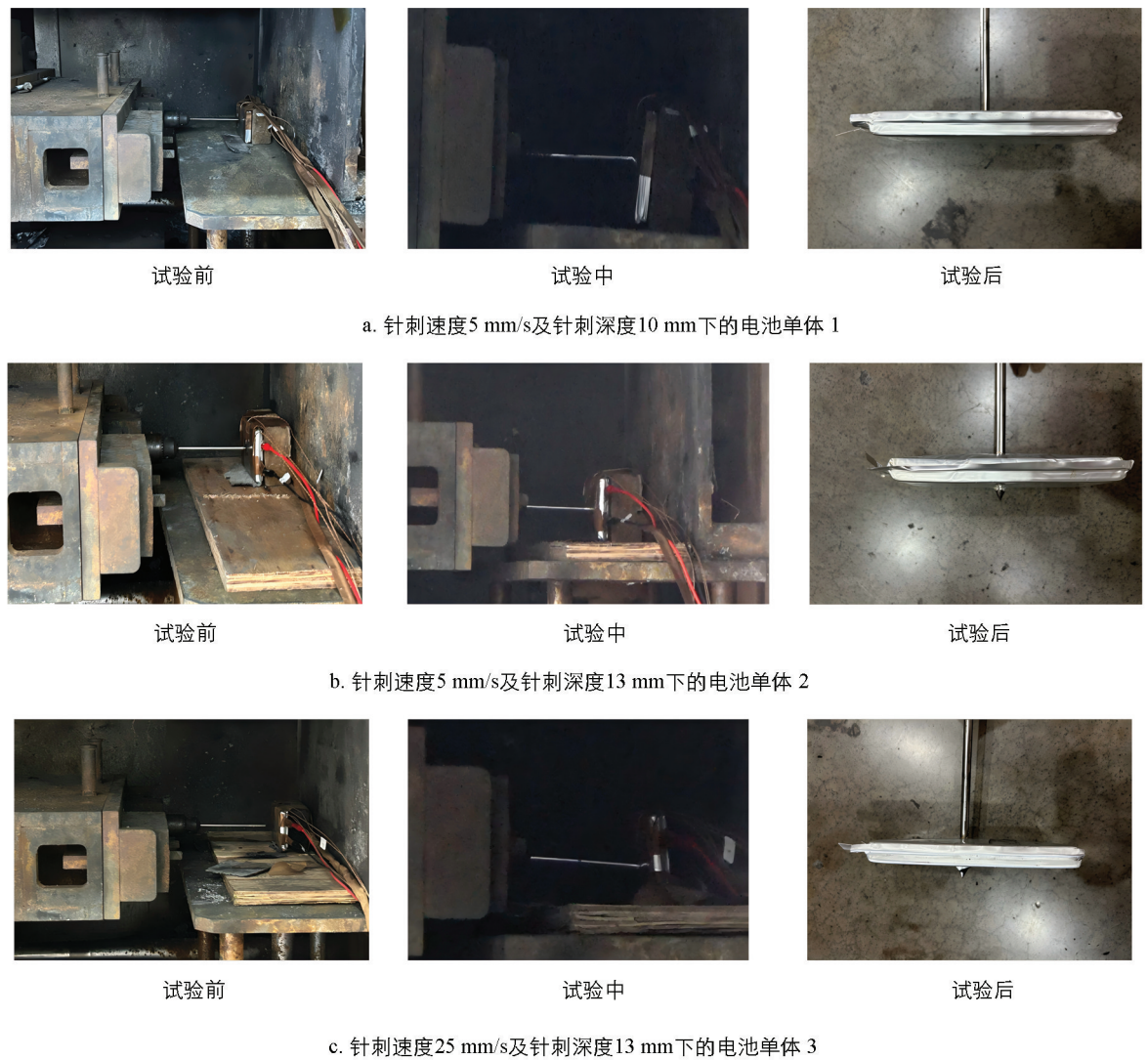
图 5 电池单体针刺试验
