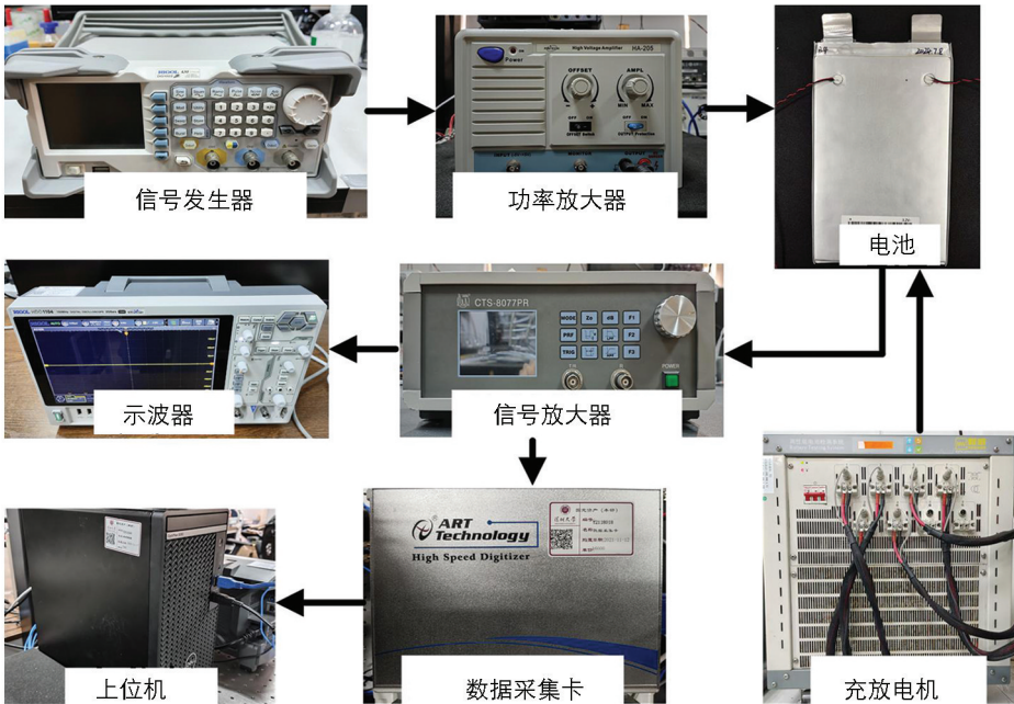
图 3 正常充放和过放电实验装置
