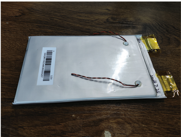
图 2 实验电池及换能器布置
