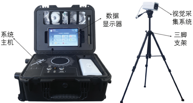
图 2 引体向上计数系统硬件
