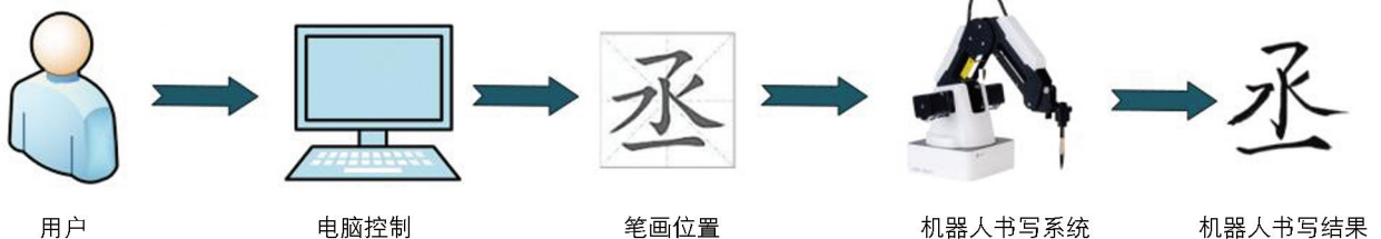
图 2 机器人书法书写系统的实际操作流程
