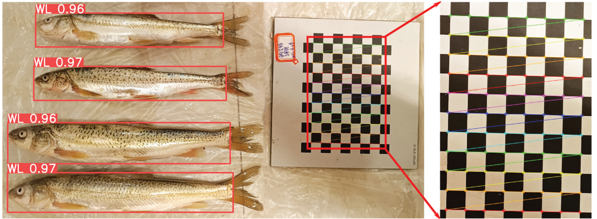
图 4 棋盘格标定板角点的检测
