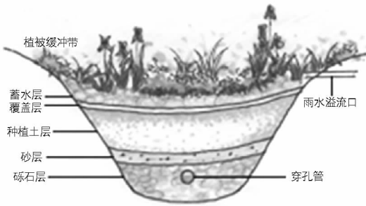
图 1 生物滞留设施结构图(作者改绘)
