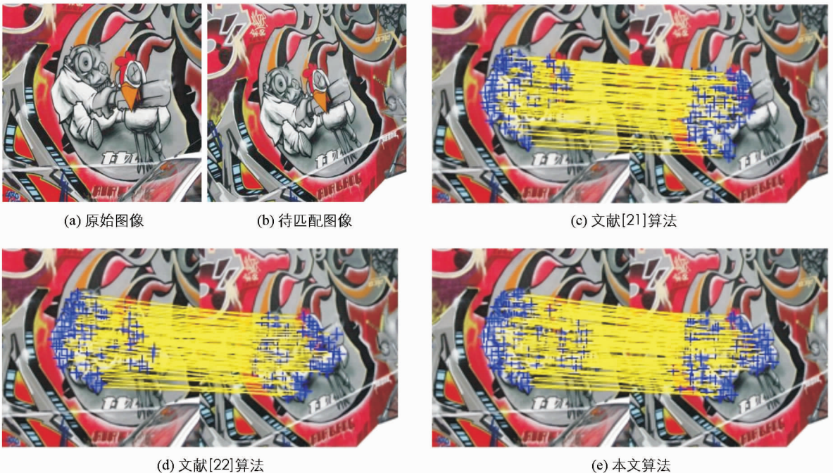
图 3 不同算法对旋转图像的匹配效果图
