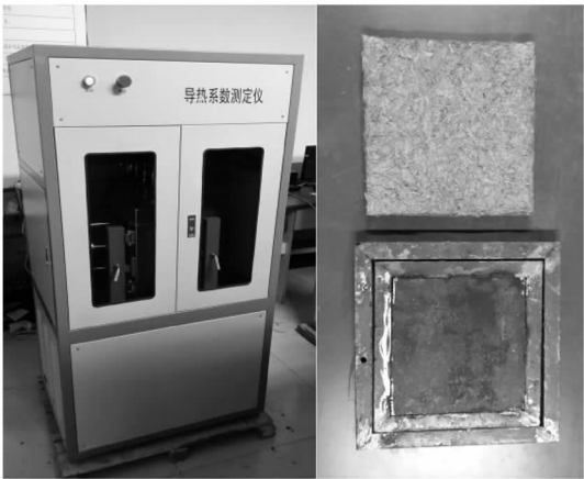
图 2 秸秆导热系数测定
