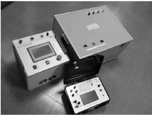
图 3 高压输电线路工频参数测量系统
