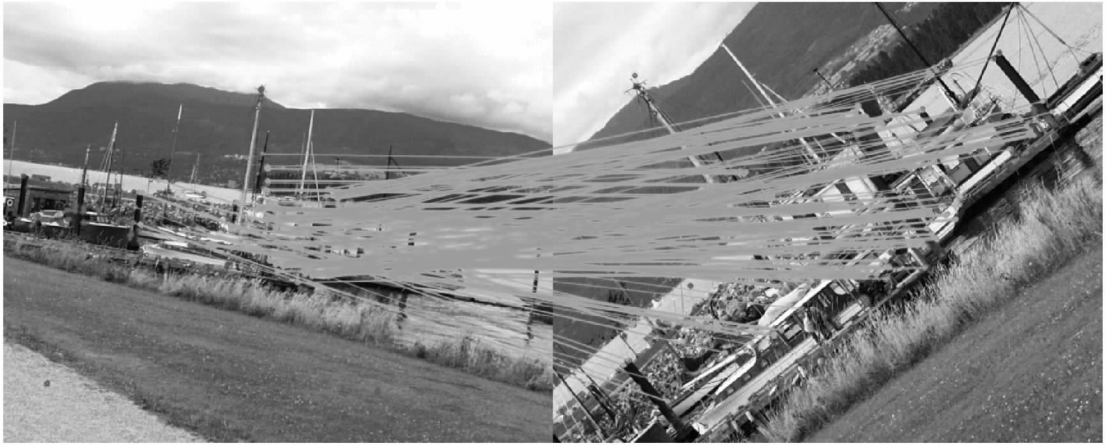
图 2 使用 SURF 描述符基于 FLANN 匹配器的匹配
