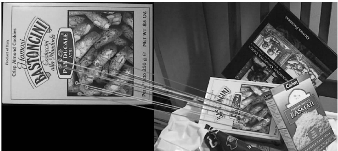
图 3 使用 SURF 描述符基于 Brute-Force 匹配器的匹配
