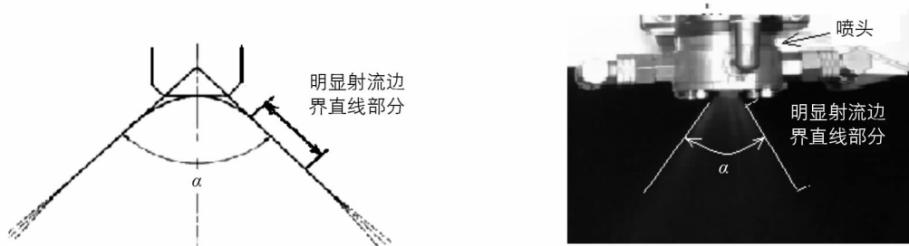
图 4 喷雾角定义与测量原理图
