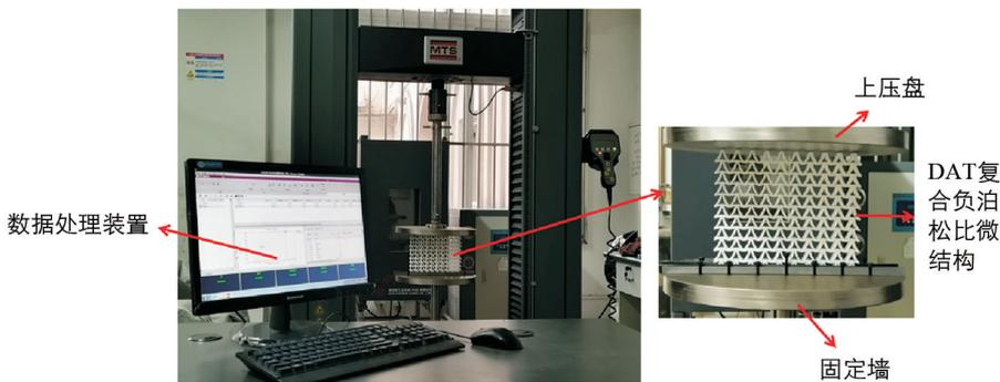
图 4 准静态压缩试验
