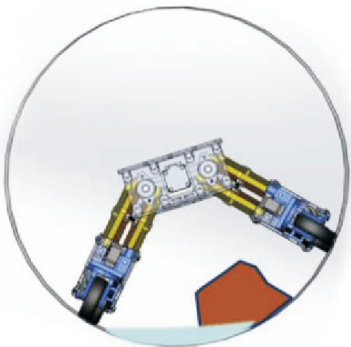
图 18 管道机器人避障运动示意
