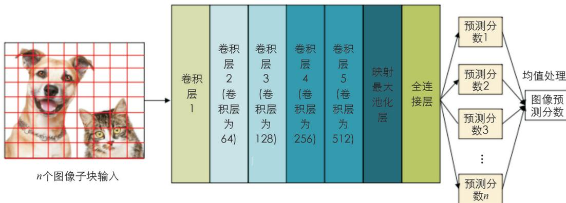
图 3 深度残差网络回归模型的示意图
