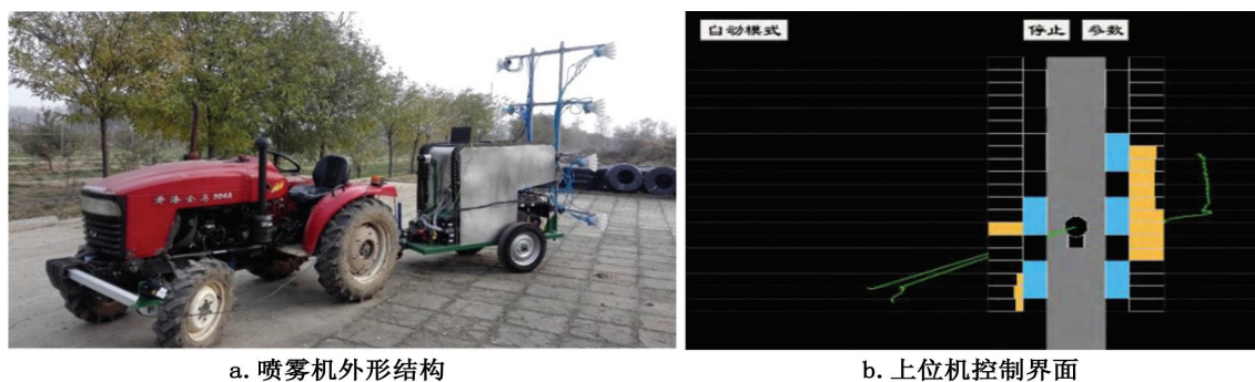
图4 中国农业大学研制的果园自动仿形变量喷雾机
