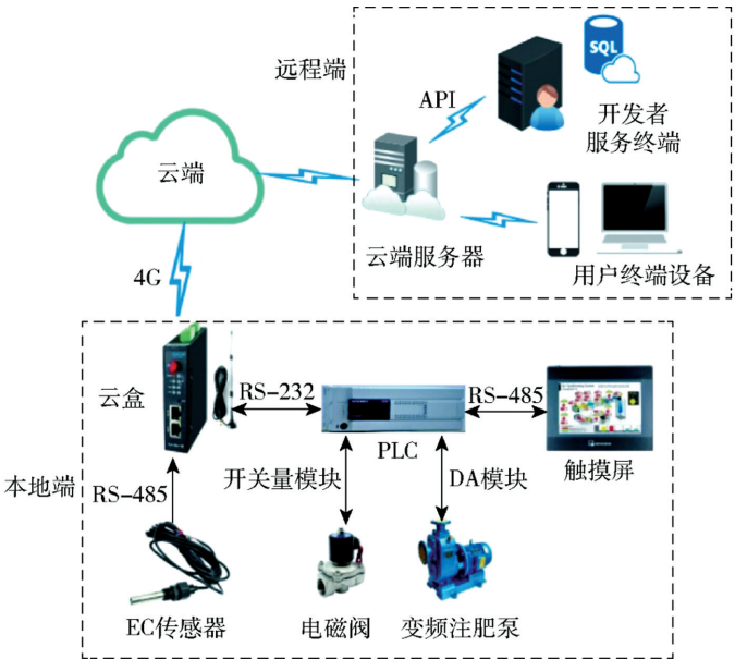
图 6 水肥一体机远程控制系统框图
