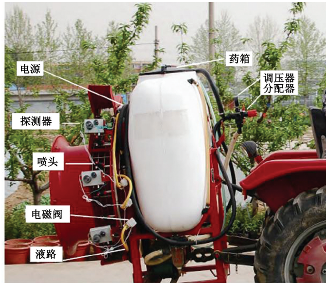
图 6 国内首台基于红外探测的果园静电自动对靶喷雾机
